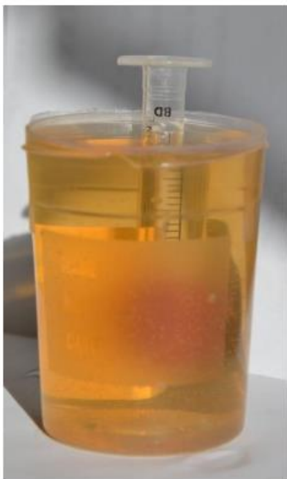
Рис. 2. Глибина занурення шприця з частинками твердого матеріалу
