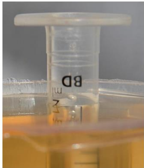
Рис. 2. Глибина занурення шприця з частинками твердого матеріалу
