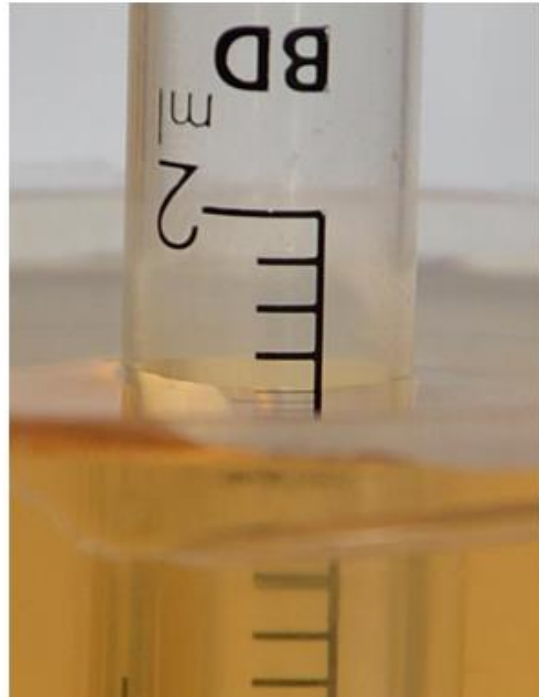
Рис. 1. Глибина занурення пустого шприця
