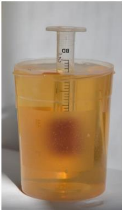
Рис. 1. Глибина занурення пустого шприця
